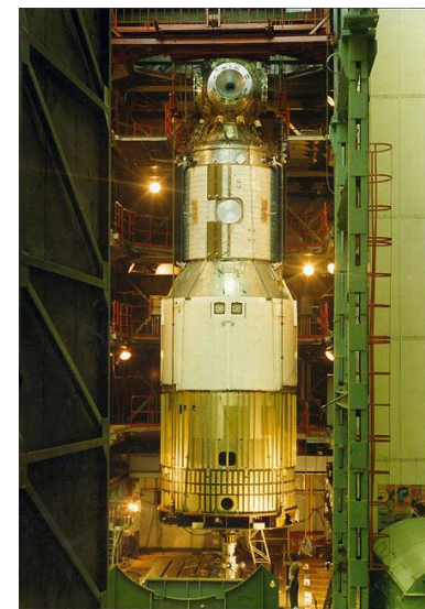
Вибропрочностные испытания модуля «Звезда» МКС
